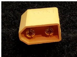
XT60 Stecker am Messgerät eingebaut
